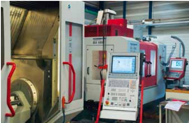
Alle CNC-Maschinen beziehen ihre NC-Programme von Visi Machining, das an acht Arbeitsplätzen installiert ist. Vorn die fünfachsigte Hermle C30U.
