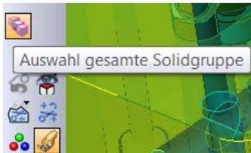
Der Zugriff auf einzelne Bauteile in den Gruppen kann über ein spezielles Icon in der Elementauswahl gesteuert werden.
