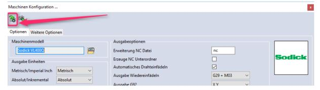
Starten Sie nun VISI2017 R2, erzeugen und öffnen ein neues PEW Projekt mit der benötigten Maschine. Verwenden Sie dieses Icon, alle gesetzten Optionen und Einträge werden aus der gespeicherten \*.SNP Datei in die Maske der Maschinenkonfiguration in VISI2017R2 übernommen.
